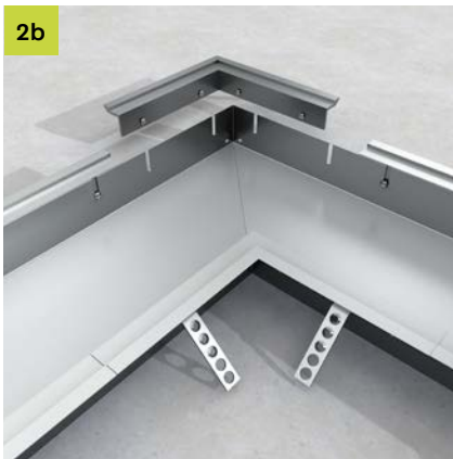
2b Das zuzuführende Kanalunterteil an die Ausklinkung schieben. Anschließend Innenprofil- und Außenprofilbogen einhängen. Der Außenbogen ist mittels Verbinder WCPS-KPEV bauseits zu montieren.
