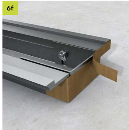
Das Endstück in das Kanalunterteil einhängen und ausrichten. Schlitz abkleben
