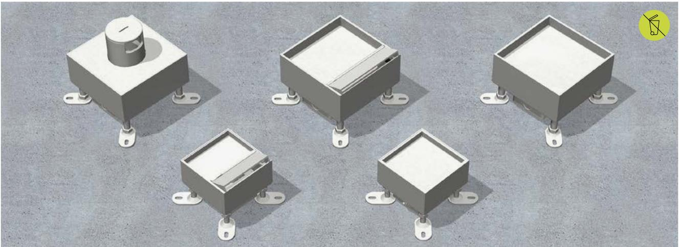
Eckige Einzelauslässe mit den Außenmaßen 115 x 115 mm oder 160 x 160 mm für den Einbau von bis zu zwei Installationsgeräten 45 x 45 mm zum Estrichdirektbau.
