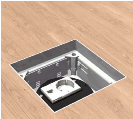
10 | Einbau Installationsgeräte In Abdeckplatte UARM-3-1 118 ein Installationsgerät 45 x 45 mm und ein Installationsgerät 22,5 x 45 mm einrasten.
