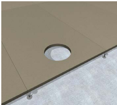
1 | Schalung ausrichten In den aufgebauten Grundboden die entsprechenden Öffnungen Ø 307 mm oder Ø 260 mm einbringen.
