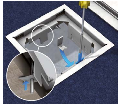
3 | Krallen montieren Die beige packten Krallen mit dazugehörigen Schrauben in die Aufnahmen im Rahmen einhängen. Krallen in die richtige Stellung bringen und mittels Kreuzschlitzschrauben anziehen. Rahmen auf festen Sitz prüfen.
