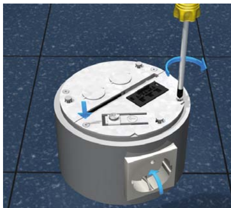
7 | Zusammenbau nach Schwachstrominstallation Nach vollständiger Installation muss die Bodenplatte und gegebenenfalls die Deckelplatte wieder mit dem Tubusauslass verschraubt werden.
