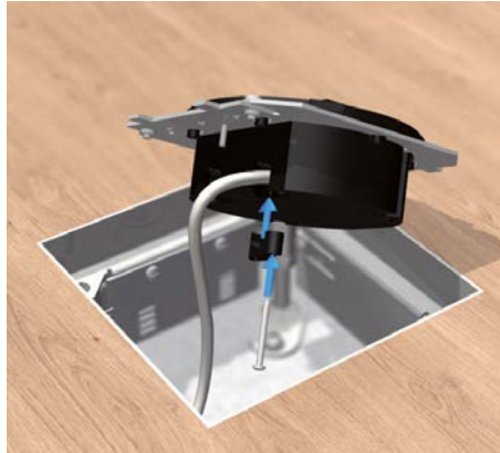
8 | Gerätebecher Gerätebecher in die Platine einsetzen, Leitungen in die Zugentlastung einführen und die Befestigungsschraube eindrehen.
