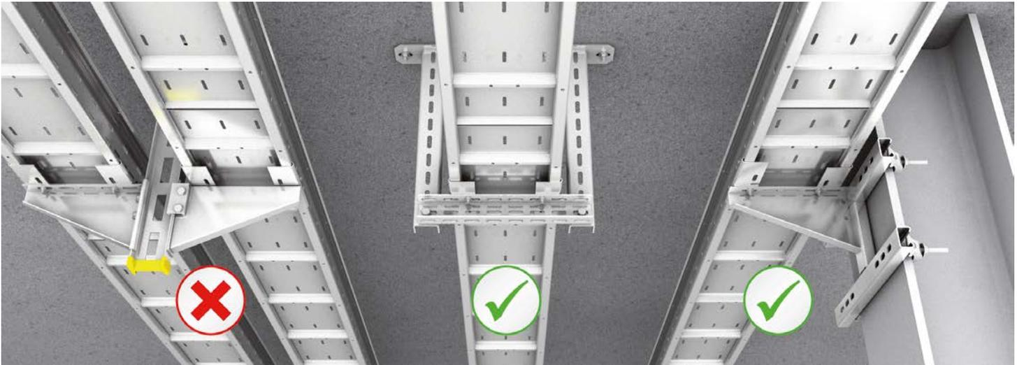
Tragkonstruktionen sind torsionsfrei zu montieren! Die Montage an Hängestielen (ein- oder beidseitig) ist untersagt. Es ist ausschließlich eine Montage an (Wand-) Konsolen oder an Pendelabhängungen zulässig.
