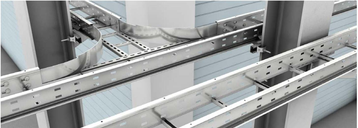
Weitspannkabelleitern dienen der Überbrückung großer Befestigungsabstände. Die Haltekonstruktionen sind ingenieurmäßig zu planen und der Einsatz von Holmstützen auf den Konsolen ist zwingend einzuhalten. Bei allen Schraubverbindungen ist das zulässige Drehmoment zu beachten.
