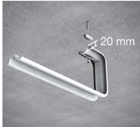
**2 | Deckenmontage mit Deckenbügel DKSL**
