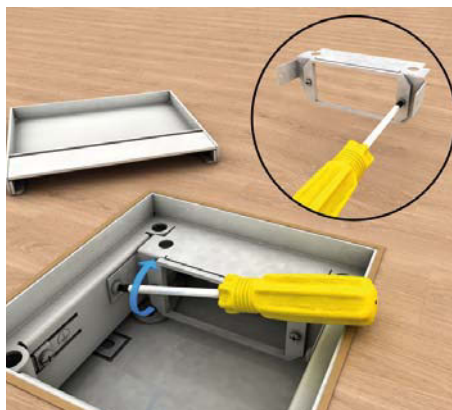
14 | Einsatzmontage Geräteträger mit Einsatzplatine UGEE vormontieren und seitlich im Kompakteinzelanschluss verschrauben.
