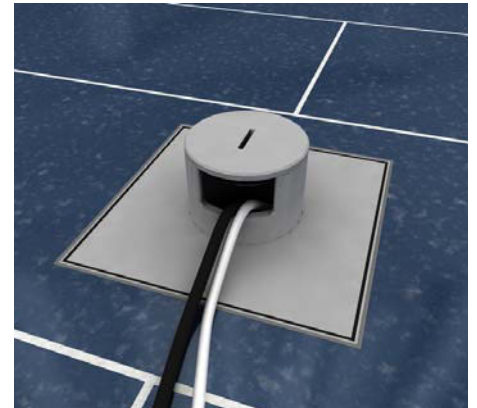
12 | Tubus Gummidichtung und Tubusdeckel einlegen, Kabel durch Tubusauslass herausführen. Bei nass gepflegten Böden Tubuseinzelanschluss einbauen. Potentialausgleich beachten.
