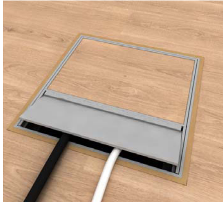
8 | Einzelauslass Gummidichtung und Kassettendeckel einlegen, Kabel durch den Kabelauslass herausführen. Bei trocken gepflegten Böden Kassetteneinbaueinheit mit Kabelauslass einbauen. Potentialausgleich beachten.
