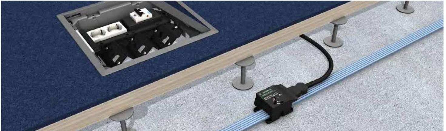
Vorkonfektionierte Gerätebecher komplett mit Snap-In-Gerätebuchse unter dem Gerätebecher, vorverdrahteten 2-fach Schutzkontaktsteckdose, mit 3-poligem Stecker an einer 2m/3m-Anschlussleitung (3 x 2,5 mm<sup>2</sup>) und FI/LS-Schalter 6 A, inklusive aller Abdeckungen und Montagematerialien. Zum Einrasten in eine runde oder eckige Einbaueinheit. Zum direkten Anschluss an 5 G 2,5 mm<sup>2</sup> Flachleitungen, Vorsicherung bis 20 A.
