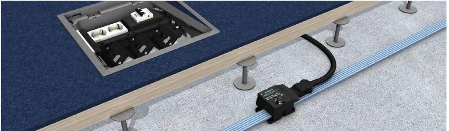
Vorkonfektionierte Gerätebecher komplett mit Snap-In-Gerätebuchse unter dem Gerätebecher, vorverdrahteten 2-fach Schutzkontaktsteckdose, mit 3-poligem Stecker an einer 2m/3m-Anschlussleitung (3 x 4 mm<sup>2</sup>) und FI/LS-Schalter 10 A, inklusive aller Abdeckungen und Montagematerialien. Zum Einrasten in eine runde oder eckige Einbaueinheit. Zum direkten Anschluss an 5 G 4 mm<sup>2</sup> Flachleitungen, Vorsicherung bis 20 A.
