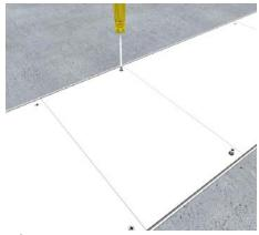
**36 | Blinddeckelabschnitt**Blinddeckelabschnitt mit zusätzlichen Senkschrauben fest im Seitenprofil verschrauben.
