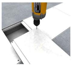
**35 | Blinddeckelabschnitt** Zusätzliche Bohrlöcher erstellen und dieses nachsenken.
