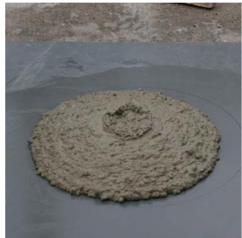
Abbildung 4: Betonkuchen nach Ermittlung des Setzfließmaßes.
