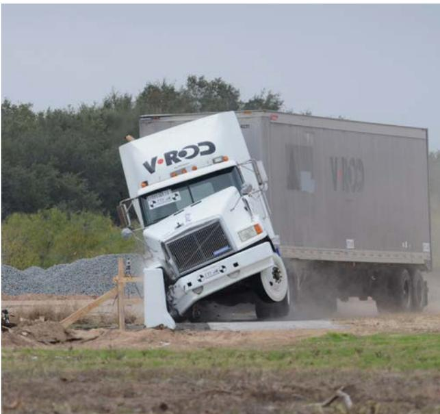
Anprallversuch eines 36.000 kg schweren Lkw mit 80 km/h an
